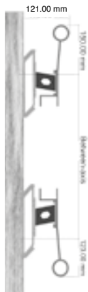
Tension de la toile sur oeillets à l'arrière du cadre.
