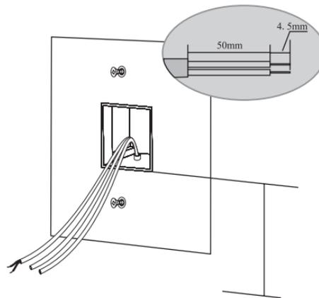
2. Ziehen Sie den Draht aus der Wand (siehe Bild) und absolieren Sie ihn auf einer Länge von 4.5mm
