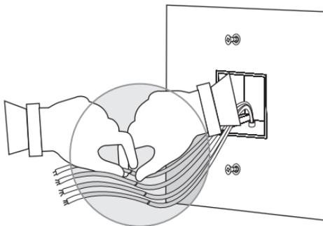
3. Verbinden Sie die Drähte mit den einzelnen Anschlüssen und prüfen Sie, ob sie fest genug sind.
