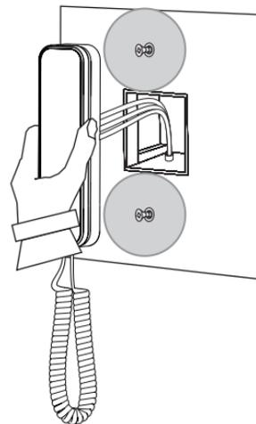
5. Nach dem Anschluss hängen Sie die Audiostation an die vorher angebrachten zwei Schrauben und vergewissern Sie sich, dass die Station sicher an der Wand befestigt ist.
