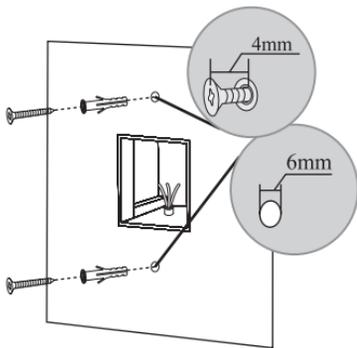
1. Bohren Sie, wie im Bild gezeigt, zwei Löcher mit 6mm in die Wand. Stecken Sie zwei Spreizdübel ein und schrauben Sie die Schrauben ein. Halten Sie dabei ein 4mm Abstand zwischen den Schrauben und der Wand.
