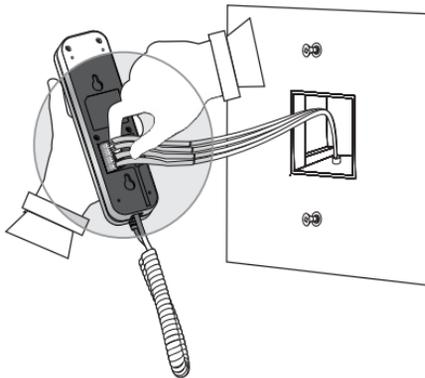
4. Schließen Sie dann den Stecker an die Audiostation an (siehe auch Anschlussdiagramm).
