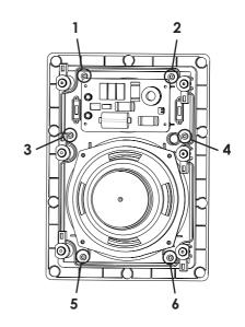
2 - Ouverture des pattes de fixation Faites pivoter les 6 pattes de fixation de manière à les tourner vers l'extérieur.
