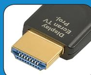
La prise HDMI Type A « Display » est à brancher sur l'entrée HDMI de l'écran TV ou du vidéo-projecteur
