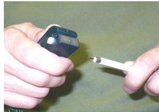
Quand le câble est correctement dénudé il apparaît comme sur la photo ci-contre où la tresse et le conducteur intérieur apparaissent complètement mis à nu
