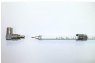
Maintenant insérer le capuchon en métal sur le câble et retourner la tresse vers l'arrière sur la gaine
