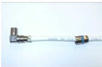
Poussez doucement le diélectrique complet avec son film métallique à l'intérieur de l'insert du connecteur jusqu'à ce que vous sentiez une résistance
