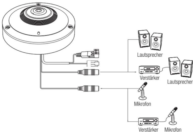
1. Verbinden Sie den AUDIO IN Anschluss der Kamera mit dem Mikrofon oder dem LINE OUT Anschluss des Verstärkers, an den das Mikrofon angeschlossen ist.
