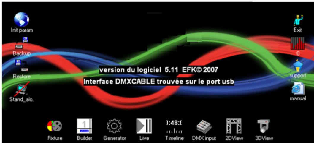
CONTROL\_BOARD est une fenêtre d'accès à tous les modules de logiciel. Cette fenêtre doit toujours être ouverte lors de l'utilisation du logiciel. Elle indique entre autre la version du logiciel en cours et l'interface détectée.
